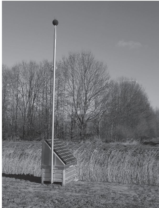
AFBEELDING 3: GELUIDMETER MET ZONNECELLEN
